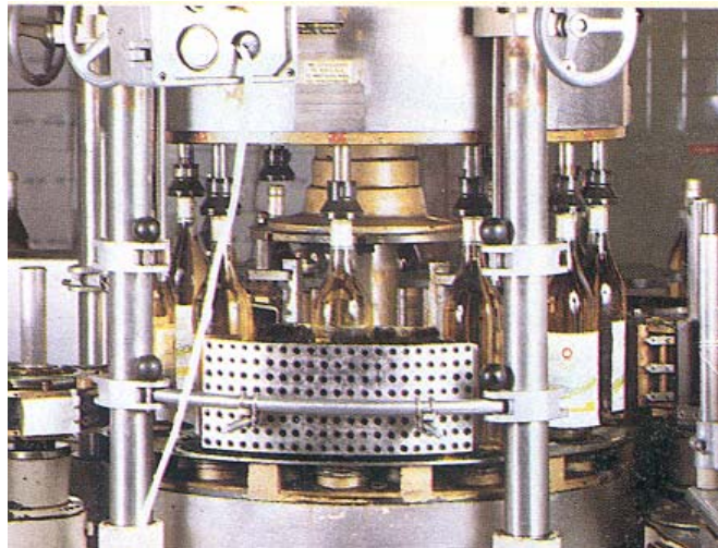
Εικόνα 4 – Εμφιάλωση κρασιού. Εδώ απαιτείται θέρμανση νερού στους 60-85 °C.
