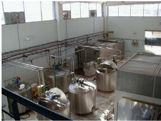
Εικόνα 2 – Ωριμαντήρες παραγωγής γιαουρτιού: Το γιαούρτι διατηρείται στους 45 °C από το θερμό ηλιακό νερό
