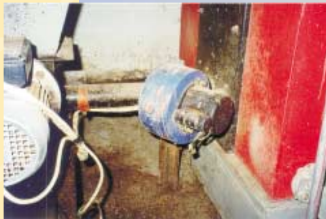
Τροφοδοσία με στερεό καύσιμο και προσαγωγή αέρα στο θάλαμο καύσης ενός καυστήρα βιομάζας
