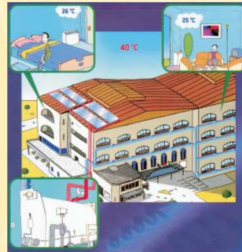
Απεικόνιση εφαρμογής ενός συστήματος ηλιακού κλιματισμού σε ξενοδοχείο
